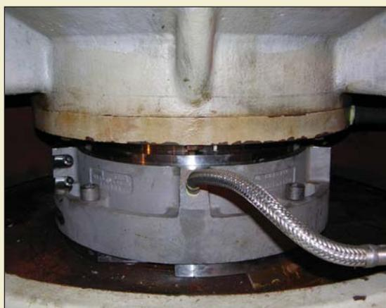
*L'installazione e la riparazione delle tenute split vengono portate a termine senza smontare i macchinari, risparmiando tempo per la manutenzione e costi d'esercizio.*
